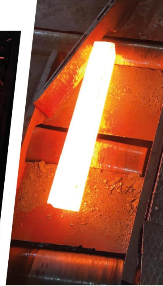
Kütük hammaddesinin tufal giderme ünitesine girmeden önceki ve sonraki hali
